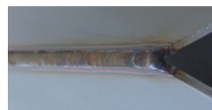
Hochfrequenzpulsen für perfekte Ecknähte
