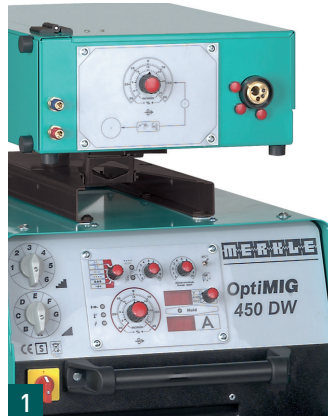
Waagerechte Montage des Drahtvorschubgeräts.
